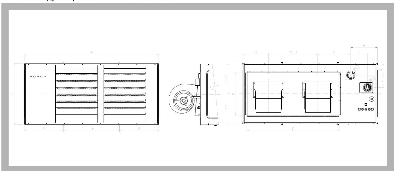
Рис. 9. Воздухонагреватель MONZUN CV - исполнение с фланцем
