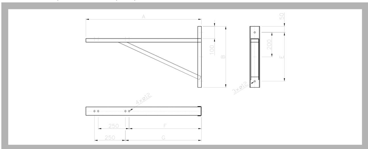
**17.3. Поворотная консоль** альтернативный вариант крепления агрегатов MONZUN VH/CV 130 520, которая позволяет поворачивание агрегата на 20° в обе стороны. После монтажа поворотную консоль нужно зафиксировать.
