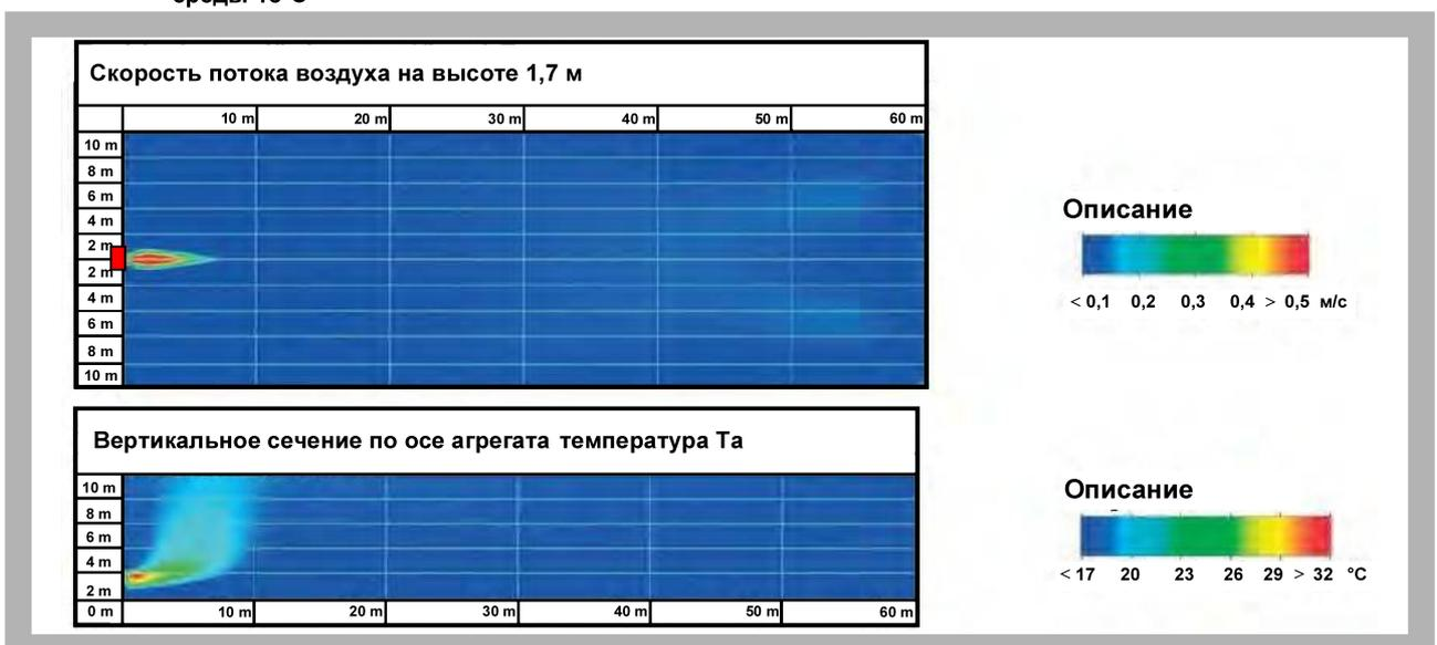
Рис. 14. MONZUN 180. Максимальный расход воздуха, жалюзи развернуты на 45°, температура среды 18°C
