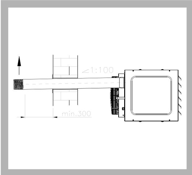
Рис. 28. Отвод продуктов сгорания через стену с KKN
