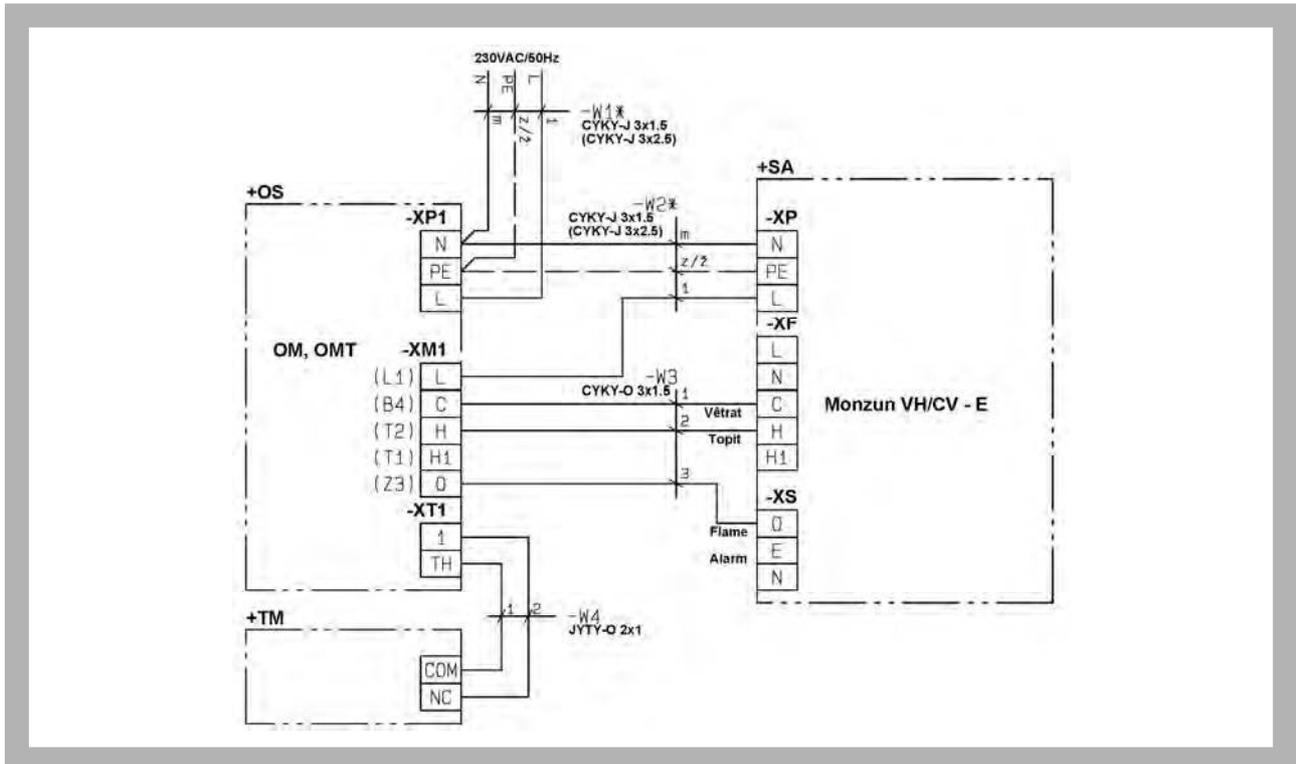
Рис. 40. Схема подключения агрегата MONZUN с шкафом управления ОМ, ОМТ для VH 130ED+ 700ED+ и CV 130ED+ 800ED+ с однофазным вентилятором.
