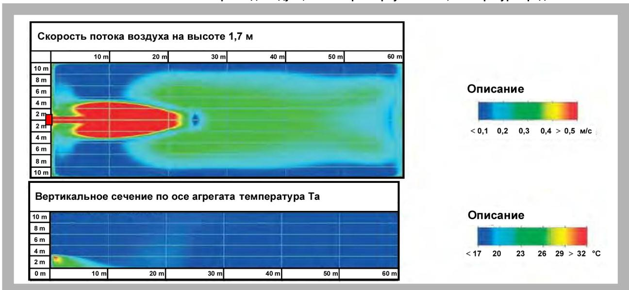
Рис. 20. MONZUN 520. Максимальный расход воздуха, жалюзи развернуты на 45°, температура среды 18°C
