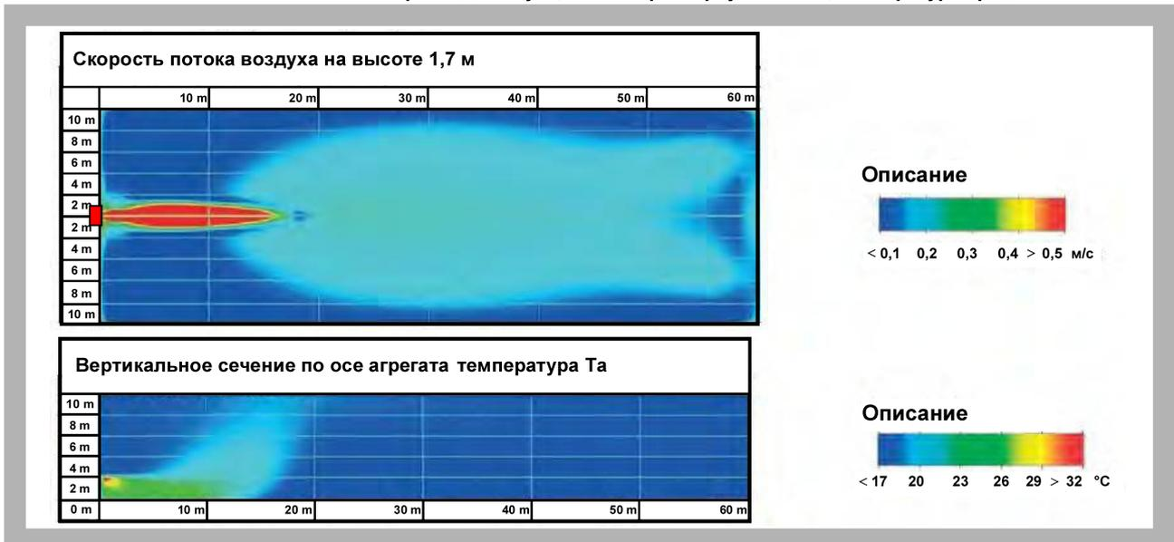
Рис. 17. MONZUN 350. Максимальный расход воздуха, жалюзи развернуты на 45°, температура среды 18°C
