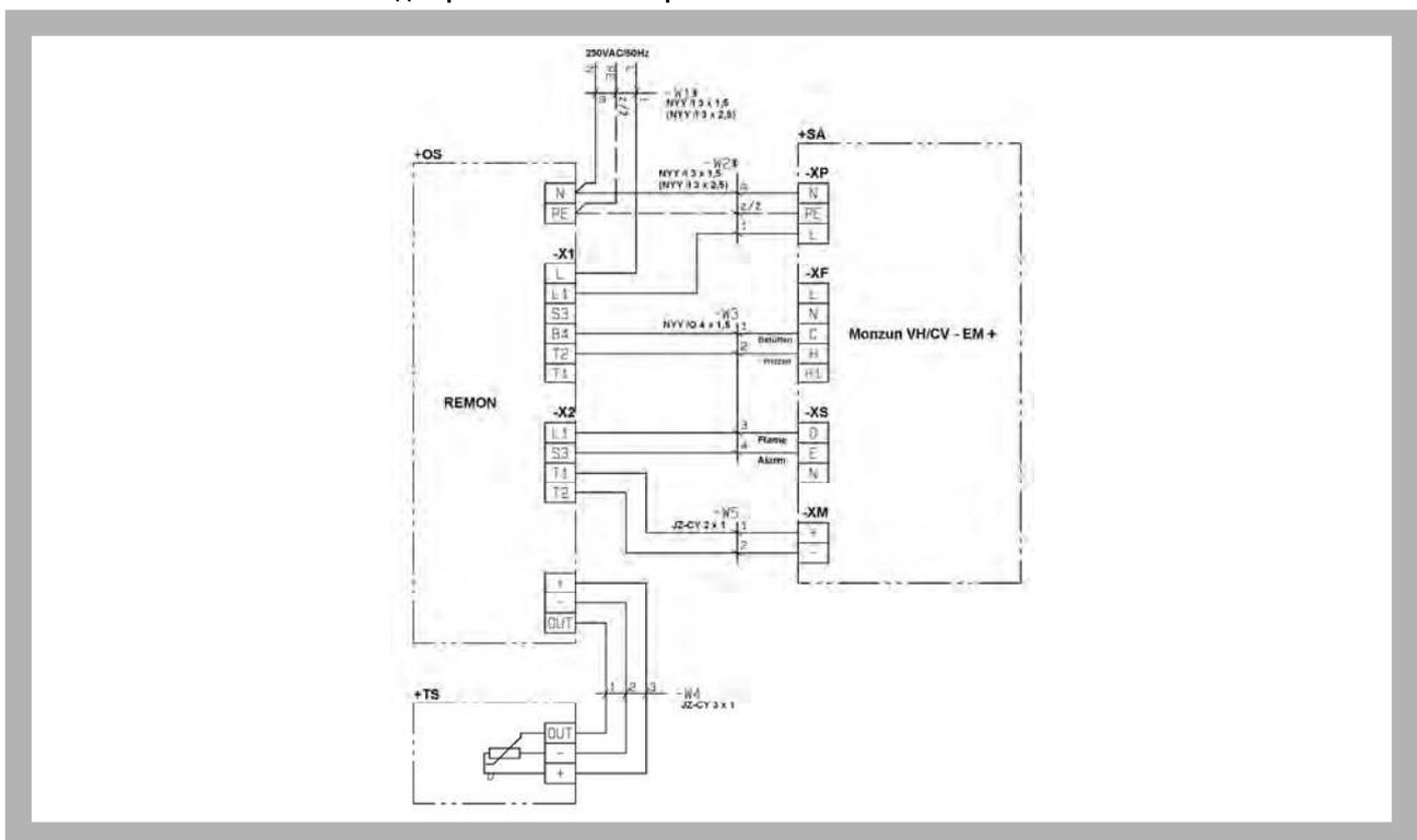
**16.2.** Тепловая защита вентилятора заключается в его отключении от сети после рассоединения термоконтакта встроенного в мотор вентилятора. Тепловая защита предохраняет включение вентилятора после снижения температуры. Включение вентилятора должен провести обслуживающий персонал.
