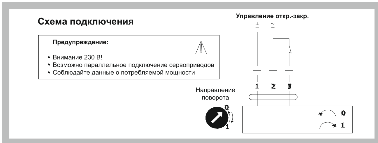
Рис. 9. Схема подключения сервопривода Belimo LM(NM) 24A
