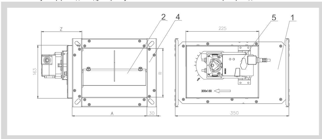
Рис. 6 Регулятор расхода воздуха прямоугольный РЕГ-МАТ-04  $\geq 400$  механическое исполнение
