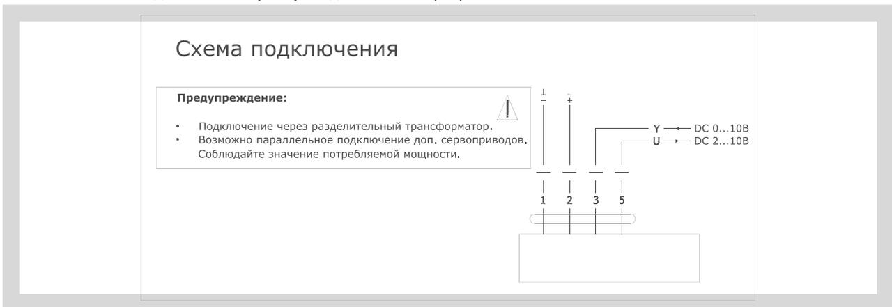
Рис. 13 Схема подключения сервопривода Belimo LM(NM, SM) 230A-S
