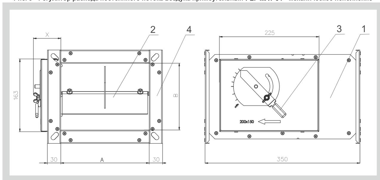
Рис. 4 Регулятор расхода воздуха прямоугольный РЕГ-МАТ-04 изолированный, механическое исполнение
