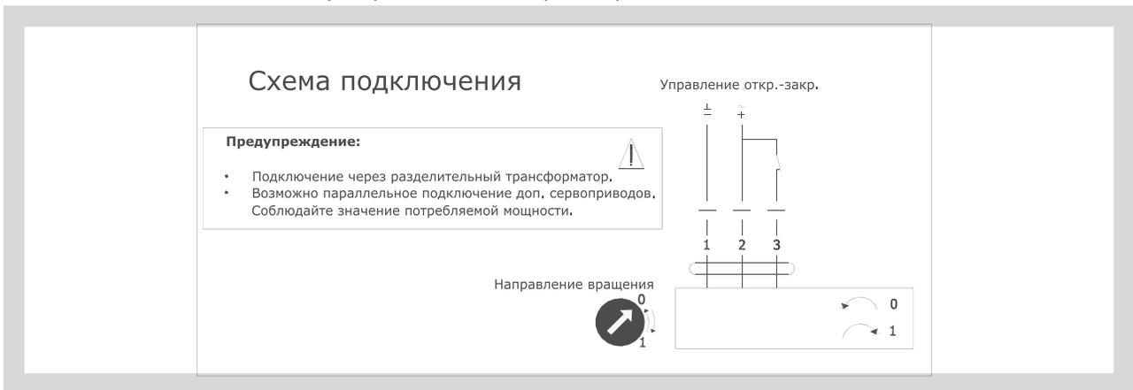
Рис. 12 Схема подключения сервопривода Belimo NM (SM) 24A-SR
