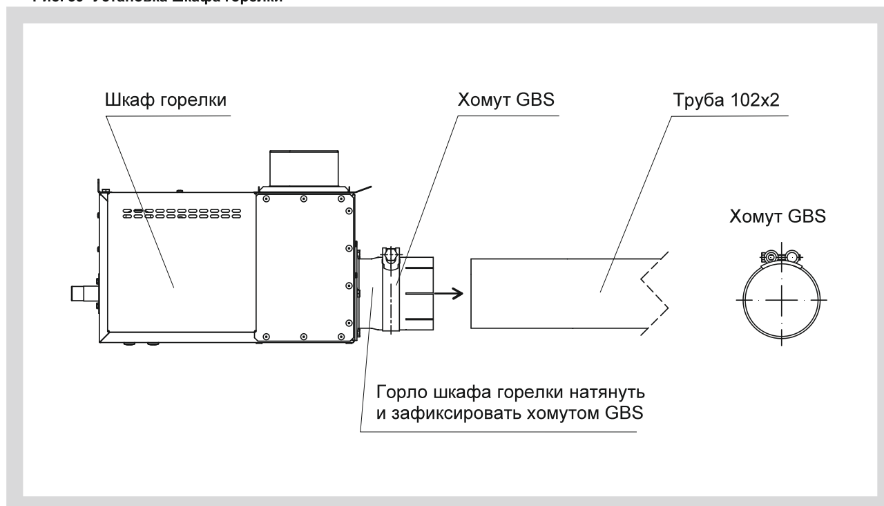
Рис. 39 Установка шкафа горелки
